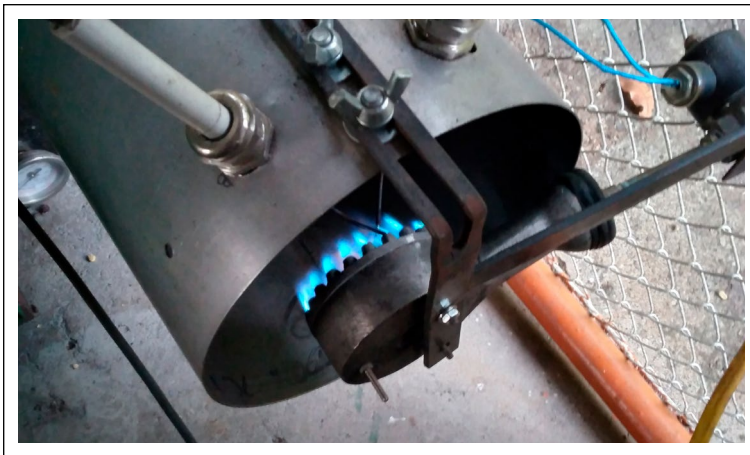
Figura 2. Apariencia de la llama en las pruebas de secado realizadas con combustión, bajo condiciones adecuadas, del GLP.
