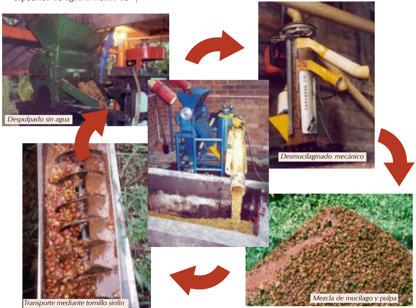
Figura 2. El módulo BECOLSUB integra diferentes desarrollos obtenidos por Cenicafé mediante la investigación científica.
