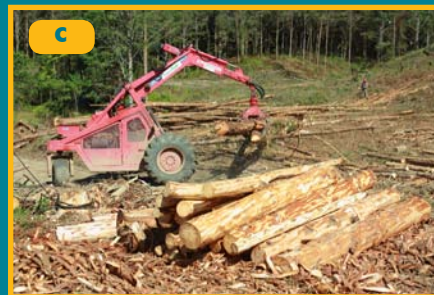
Figura 65. a. Winche de doble tambor (ida y venida), utilizado para extracción de madera; b. y c. Winche de un solo tambor cargador, donde el estrobero debe desplazar el gancho para amarrar la carga.
