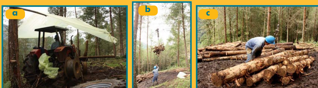
Figura 63. "Castor paisa" para extracción de madera. a. Tractor sin rueda derecha y adaptación de tambor con cable para extracción de madera; b. Cable que trae madera estrobada, accionada por el castor paisa; c. Liberación de estrobo 1 y desamarre de trozas.
