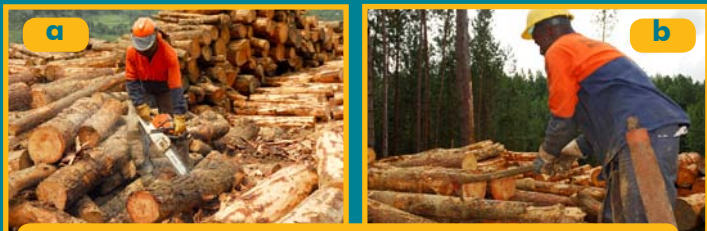
Figura 67. a. Dimensionado de la madera; b. Arrastre de troza para efecto de iniciar descortezado.
