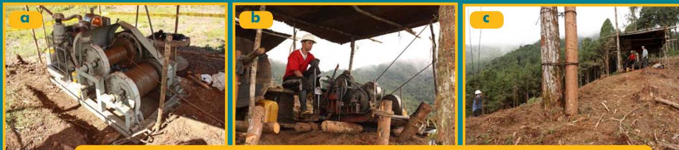
Figura 65. a. Winche de doble tambor (ida y venida), utilizado para extracción de madera; b. y c. Winche de un solo tambor cargador, donde el estrobero debe desplazar el gancho para amarrar la carga.
