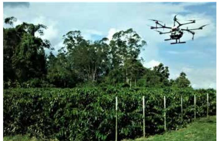
**Figura 12.** Dron usado para la aspersión de pesticidas en el cultivo del café.
