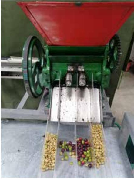
**Figura 56.** Despulpadora de cilindro horizontal adaptada para separar frutos verdes.
